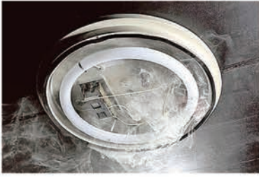
▲不適切な取り付け方法再現実験で発煙したLEDランプ。(NITE提供)
