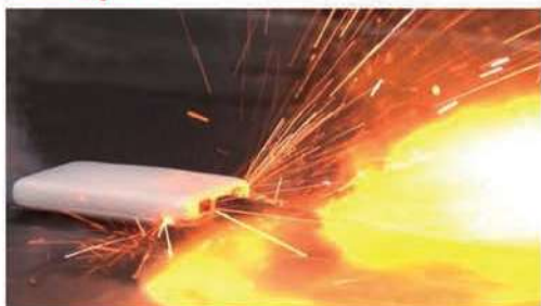
実験で発火するモバイルバッテリー
