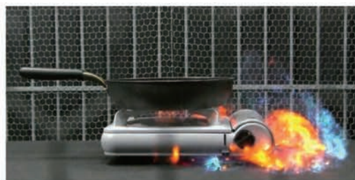
劣化したカセットボンベからガスが漏れ、引火した(再現実験)
