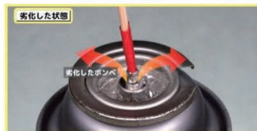
劣化したカセットボンベからガスが漏れる様子。ガス漏れが分かりやすいように塗った液体が泡立っている(再現実験)
